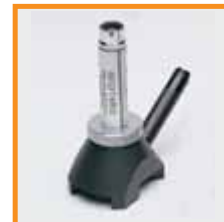
5. Используя коэффициент шкалы (количество мкм в одном делении) рассчитайте толщину покрытия
