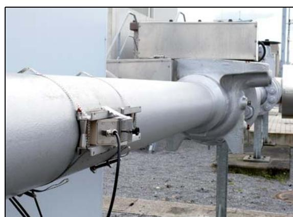
Измерение с взрывозащищенными датчиками
